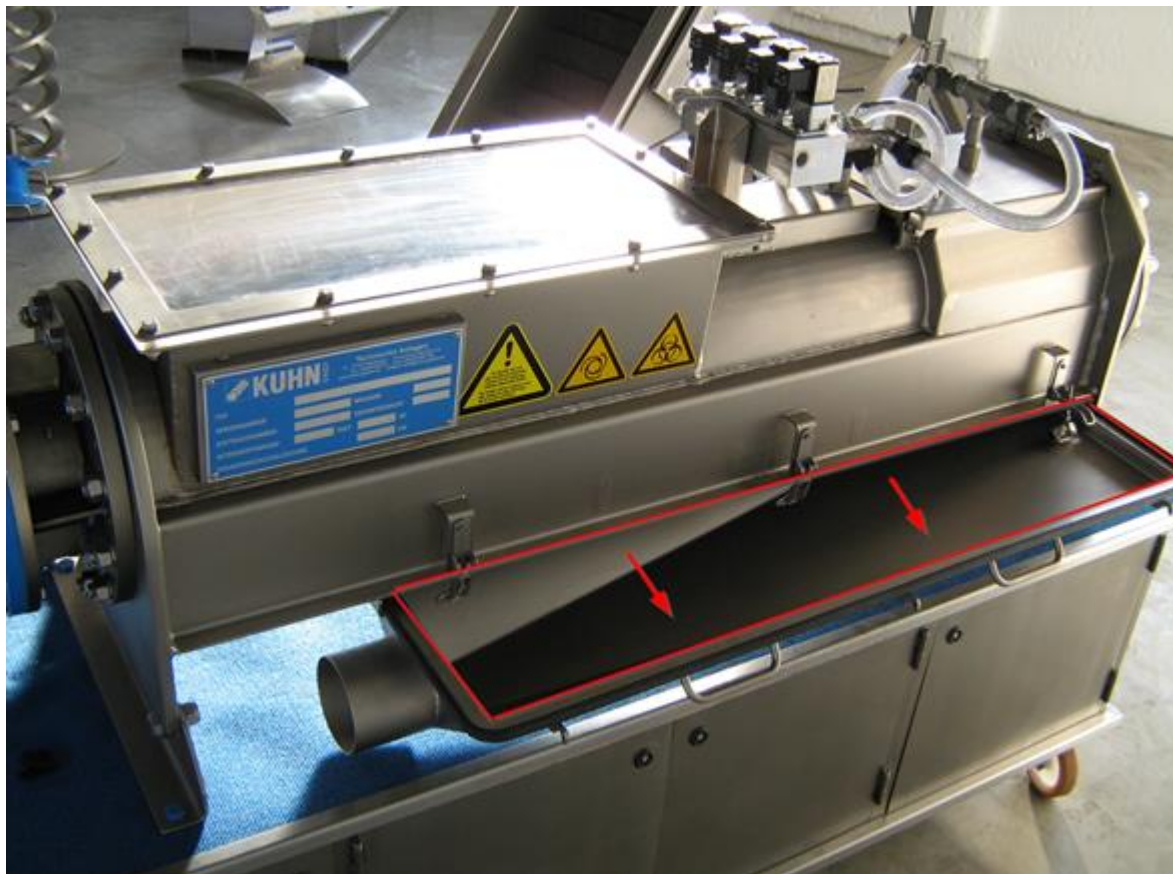
Ukázka vysunutí spodní části mycího lisu
