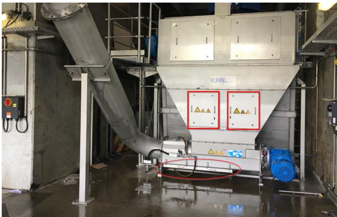
Ukázka otevírání čela plnicího trychtýře pro údržbu (červeně ohraničená část)
